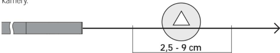
Objekty, které jsou daleko mimo rozsah zaostření, se mohou jevit neostře.
